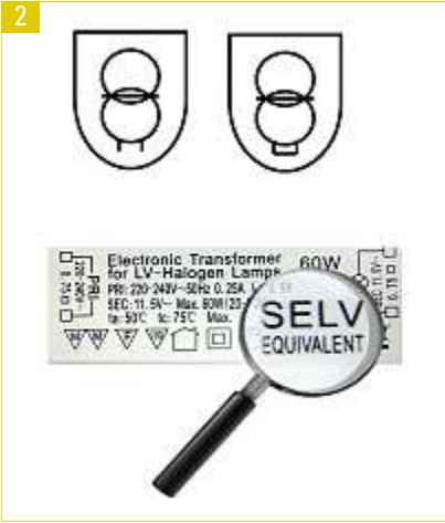
Kennzeichnung von Sicherheitstransformatoren.
