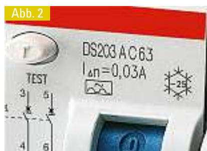
Typ A, pulsstromsensitiv. Für Hausinstallationen in der Schweiz generell anzuwenden.
