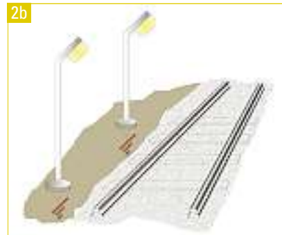
Kandelaber einzeln geerdet im System TT.
