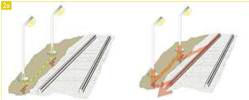
Kandelaber mit Schutzleiter verbunden im System TN: Bahnstrom wird durch den Schutzleiter der Kandelaber geleitet.
