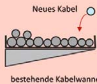
2 Erweiterung in bestehenden Kabelkanal.
