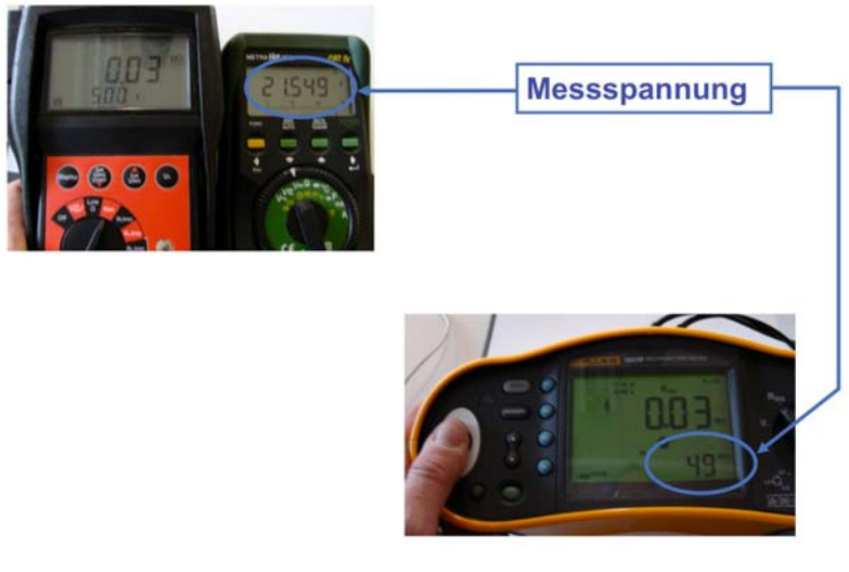
Isolationswiderstand 30 kΩ Messbereich 500 V.
