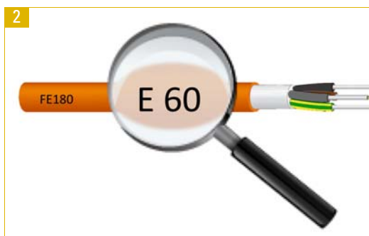
Kabel für Funktionserhalt.
