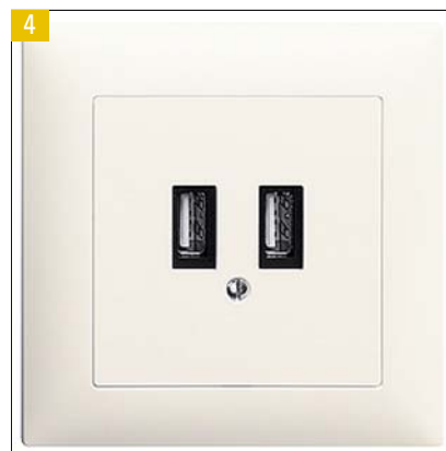
USB-Steckdose im Bereich 1 eines Badezimmers nicht erlaubt, da Stromquelle nicht ausserhalb des Bereiches ist und IP X4 nicht eingehalten werden kann (Bild: Feller AG)
