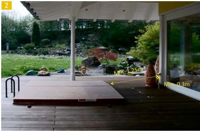
Zwei Beispiele von Bassins auf Terrassen. Die Steckdosen müssen ausserhalb des Handbereiches der Bassins angeordnet sein.
