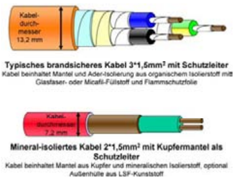
Bild 4: Mineral isolierte Leitungen im Querschnitt.
