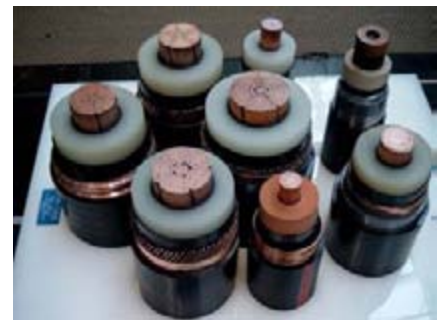
Bild 3: Bei Hochspannungskabeln dominiert beim Gesamt-Querschnitt bzw. Volumen der Isolierstoff den Leiterwerkstoff.
